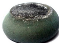
Рисунок 2.22 – Форма образцов после деформации
