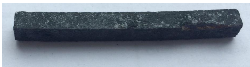
Рисунок 7.18 – Внешний вид образца №8 после испытаний на жаростойкость при температуре 1500 С
