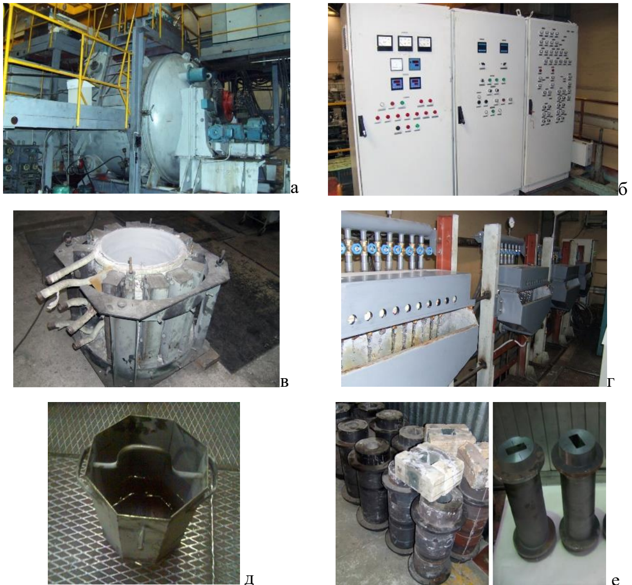
Рисунок 6.1 – Внешний вид вакуумно-индукционной печи ИСВ-0,16 (а), модернизированных узлов: пульты управления (б), плавильный узел (в), система охлаждения (г), загрузочная корзина (д), изложницы (е)
