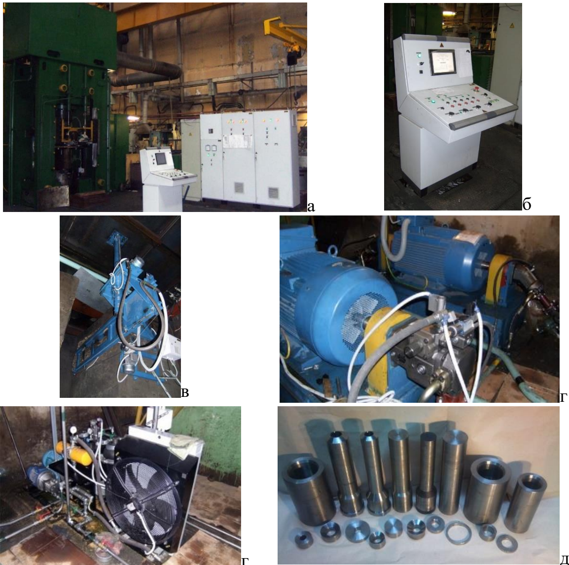
Рисунок 6.3 – Внешний вид трубопрофильного гидравлического пресса П-8439 усилием 8МН (а), модернизированных узлов: терминал управления (б), приемный узел (в), насосы(г) и маслостанция (д) гидравлической системы, прессовая оснастка(е)
