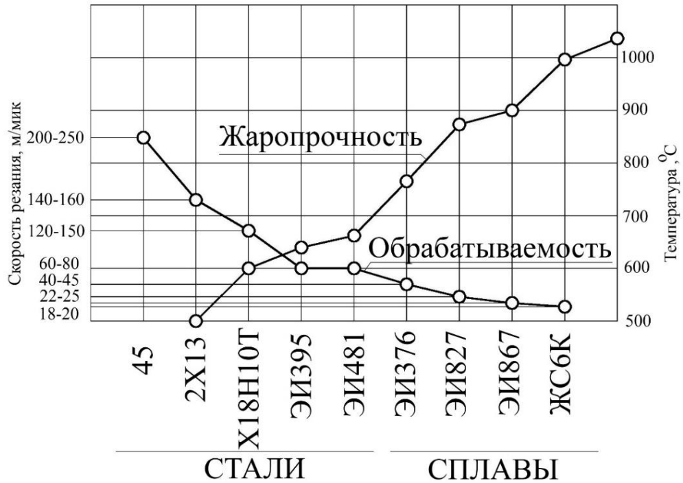
Рисунок 4.1 – Жаропрочность сталей и жаропрочных сплавов, температура в зоне резания и допустимая скорость резания при их обработке резанием твердым сплавом ВК8[196]
