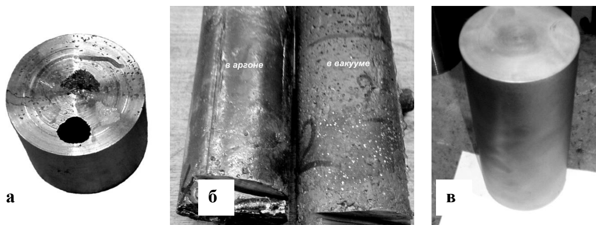
Рисунок 2.4 - Слитки вакуумно-индукционного переплава: усадочная раковина и пористость в подприбыльной части (а); поверхность слитков, отлитых в аргоне и вакууме (б); слиток без усадочных дефектов (в)
