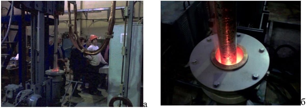
Рисунок 6.2 – Внешний вид установки ЭШП-0,05 (а), кристаллизатор (б)
