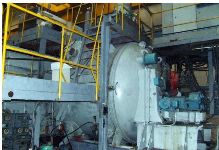
Рисунок 2.3 – Внешний вид установок вакуумно-индукционной выплавки: «Кристаллизатор 105» (а) и ИСВ-016 (б)
