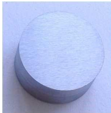
Рисунок 5.1 – Внешний вид образца сплава Х65НВФТ до испытаний при нагреве в вакууме
