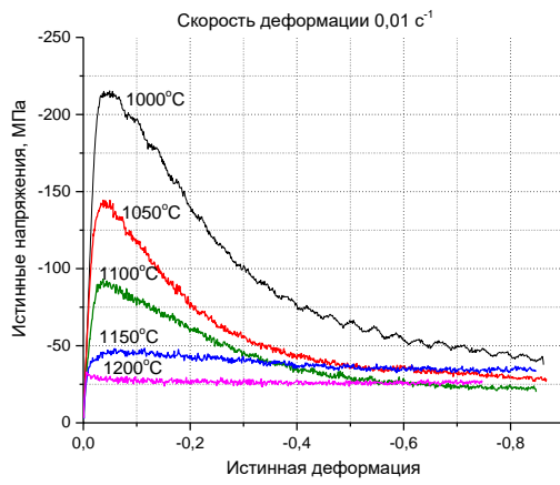
Рисунок 2.21 – Экспериментальные диаграммы деформации сплава в интервале температур (1000-1200) °С и скоростях деформации 0,01 и 0,001 с -1
