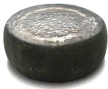
Рисунок 2.22 – Форма образцов после деформации
