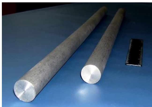
Рисунок 2.44 – Внешний вид дефектного прутка (а), капсулы (б) и годного прутка (в)
