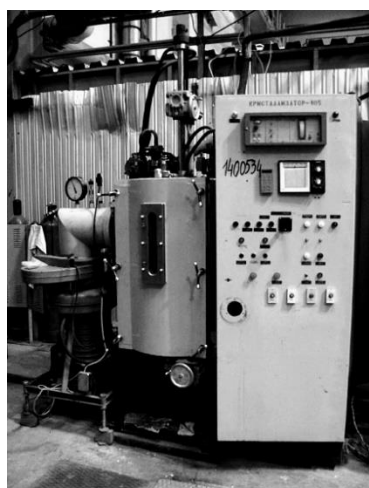
Рисунок 2.3 – Внешний вид установок вакуумно-индукционной выплавки: «Кристаллизатор 105» (а) и ИСВ-016 (б)
